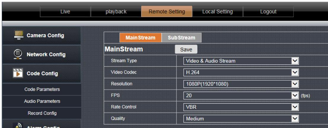
**Основной поток и вторичный поток:** Установите параметры основного и дополнительного потоков камеры.
